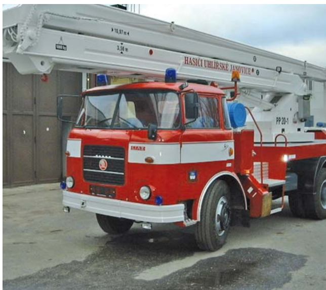
Nově zrekonstruovaná vysokozdvíhací plošina PP 20-1.
